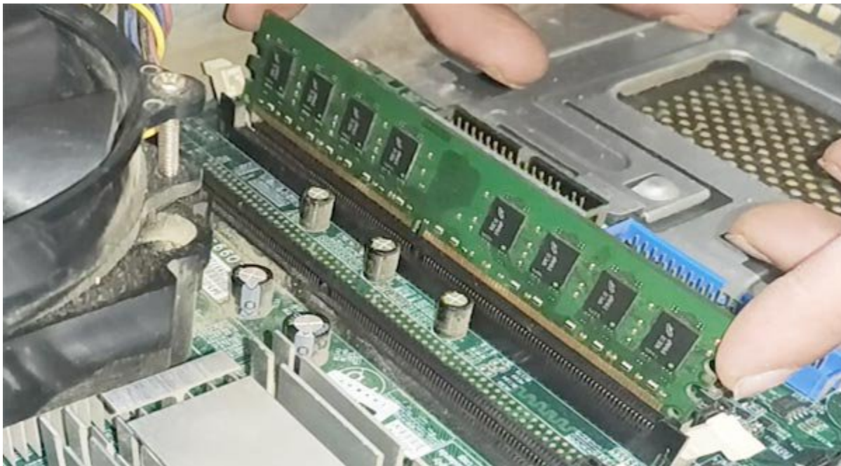
Fig: Install RAM
